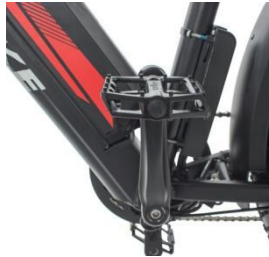
Das rechte Pedal zieht im Uhrzeigersinn
