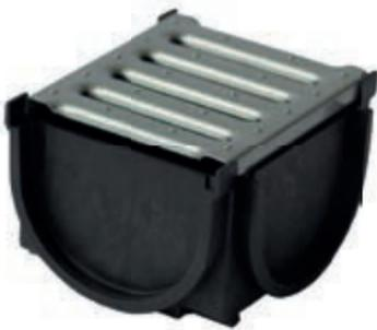
Durch Entfernen der Vorformung am Eckelement (Zubehör) an den dafür vorgesehenen Schnittführungen lassen sich Eck-, T- und Kreuzverbindungen herstellen.
