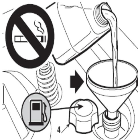
1. Schrauben Sie den Tankdeckel (4) vom Benzintank auf. Dieser befindet sich hinter dem Sitz.
