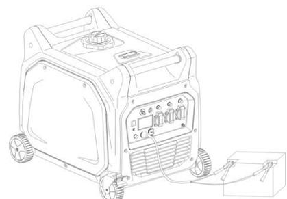
**⚠️ WARNUNG** Um zu vermeiden, dass Funken an den Klemmen der Batterie entstehen, schließen Sie zunächst die Ladekabel an die Batteriepole und dann an den Generator an. Wenn Sie die Kabel trennen, tun Sie dies zuerst am Generator.
