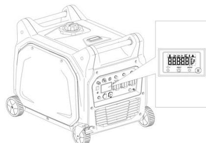
Wenn die Leuchte «FAULT» rot leuchtet, trennen Sie zuerst die elektrischen Verbraucher, überprüfen Sie, ob die Kühlfunktion des Generators nicht durch z.B. abgedeckte Kühlschlitze verhindert wird. Halten Sie dann die RESET-Taste für 1 Sekunde lang gedrückt. Wenn die «FAULT» Leuchte erlischt und die «OUTPUT» Anzeige wieder grün leuchtet, können Sie die elektrischen Verbraucher wieder angeschlossen werden. Andernfalls den Motor abstellen und den Generator überprüfen.
