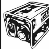
Benutzen Sie das Gerät **NIE** in geschlossenen Räumen wie Häuser, Zelte, diverse Camping Fahrzeuge oder Boote. **Selbst dann NICHT**, wenn Türen und Fenster offen sind, oder andere Lüftungsvorrichtungen verwendet werden. Um das Einatmen von Abgasen zu vermeiden, das Gerät nur **DRAUßEN** verwenden, möglichst weit entfernt von offenen Fenstern, Türen und Lüftungsschächten.
